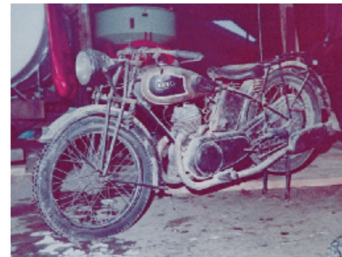
Høyre side viser flere av de modifikasjonene som er utført: Annet eksosanlegg, annen girkasse med fotgirring i stedet for håndgir, batteri og annet elektrisk anlegg.
